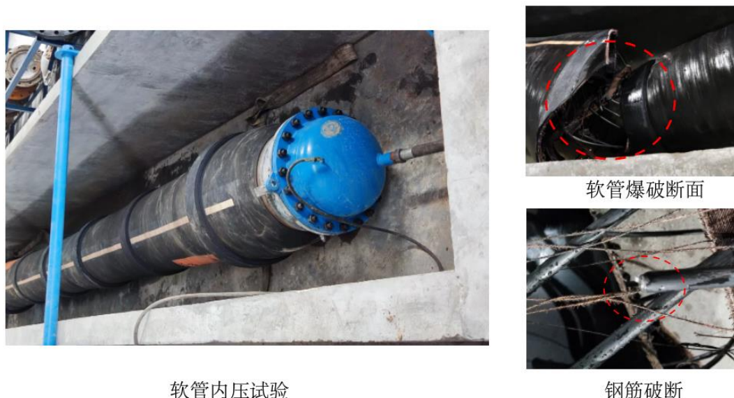
图 5 软管内压极限承载试验
